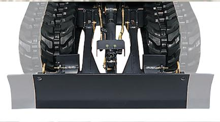
Par le simple maniement d'un axe, la largeur de la lame peut être modifiée rapidement.
