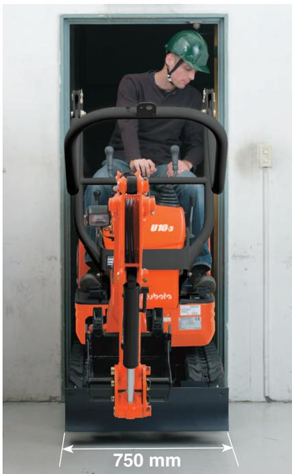
Lorsque la largeur du châssis est réduite à 750 mm, la U10-3 peut passer par la plupart des portes facilitant ainsi l'accès à l'intérieur des bâtiments.
